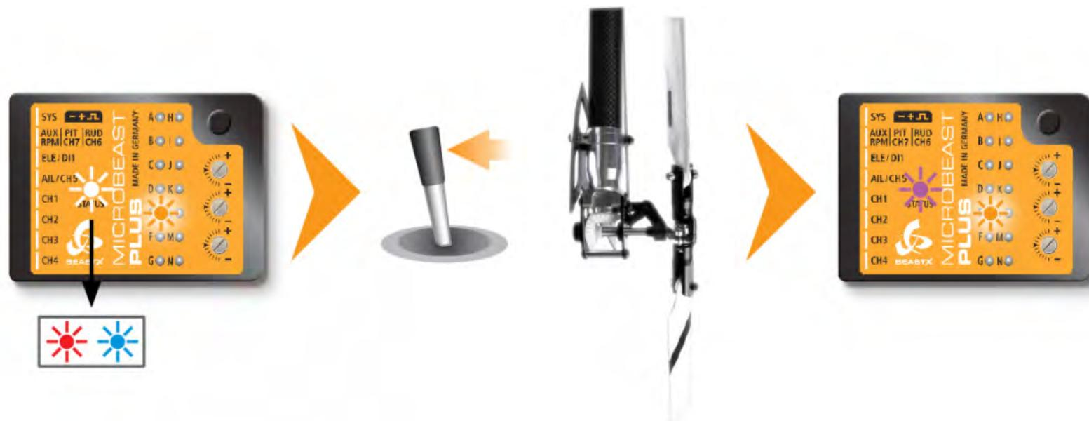
⚠ Achten Sie darauf, dass die an der Fernsteuerung gesteuerte Richtung auch der Richtung entspricht, in die sich der Helikopter drehen soll. Sollte dies nicht der Fall sein, benutzen Sie bitte die Servoumpolung fur das Heckservo/den Hecksteuerkanal in Ihrer Fernsteuerung. Wenn Sie sich nicht sicher sind, in welche Richtung sich der Heckrotor bewegen muss, ziehen Sie die Bedienungsanleitung Ihres Helikopters zu Rate.
