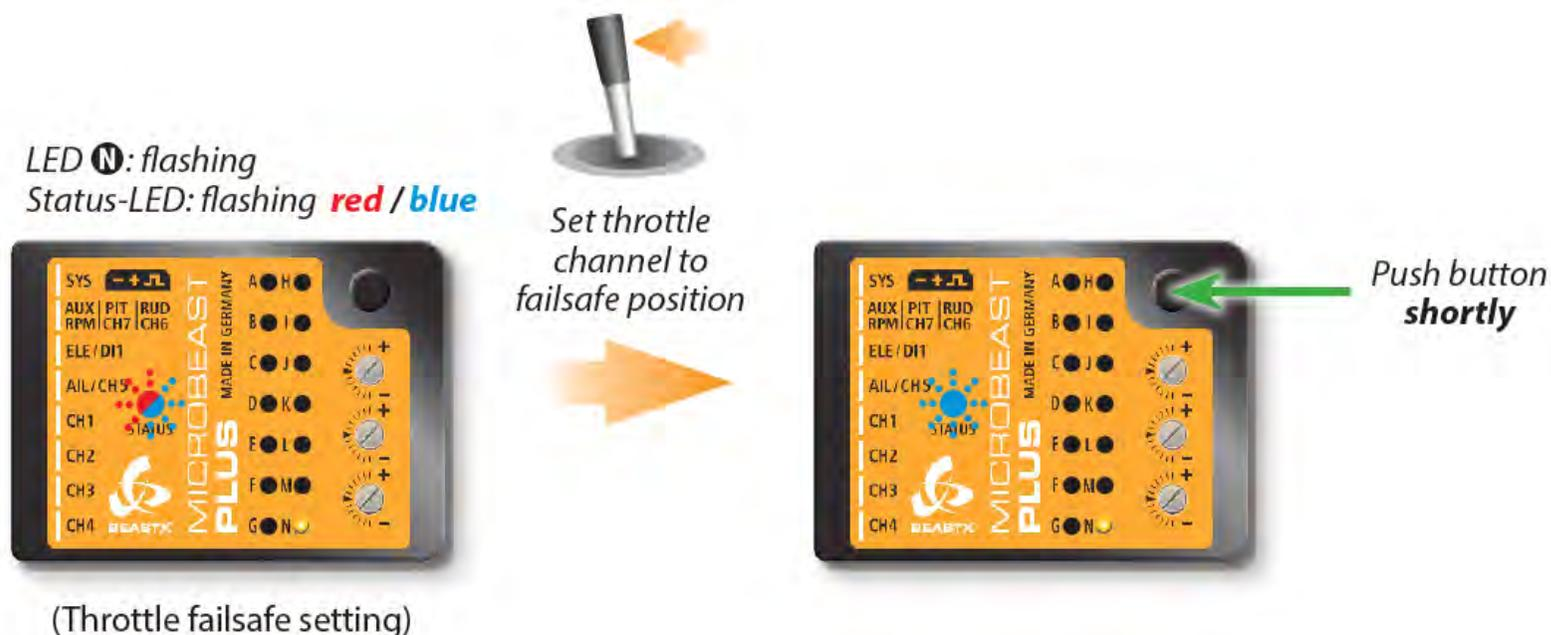
**⚠ Für die Failsafeeinstellung ist der Ausgang [CH5] aktiv und reagiert entsprechend auf Bewegungen des Motorkanals, so dass die Failsafeposition kontrolliert werden kann.** Koppeln Sie bei Elektromodellen den Motor vorher unbedingt vom Hauptgetriebe ab, so dass der Rotor des Helis nicht aus Versehen angetrieben wird!
