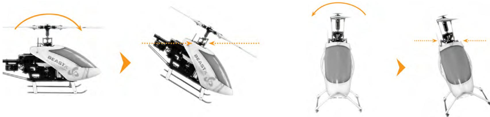
Sollte dies bei Ihrem Helikopter nicht der Fall sein, können Sie durch Antippen des Heckrotorsteuerknüppels in eine Richtung die Sensorrichtungen verändern. Wiederholen Sie dies sooft, bis die Korrekturen sowohl auf Roll als auch auf Nick in die richtige Richtung ausgeführt werden. Die momentan ausgewählte Variante wird zur Kontrolle durch die Farbe der Status LED dargestellt.
