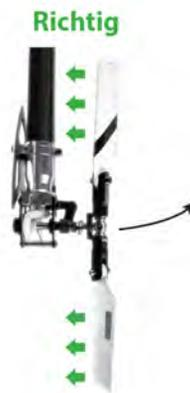
Wenn Sie das Heck mit der Hand nach rechts bzw. die Spitze des Helis nach links bewegen, wird der Heckkreisel eine Steuerbewegung nach rechts ausführen, genauso als würden Sie mit dem Hecksteuerknüppel nach rechts steuern.
