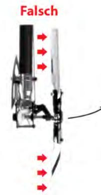
Wenn Sie das Heck mit der Hand nach rechts bzw. die Spitze des Helis nach links bewegen, wird der Heckkreisel eine Steuerbewegung nach links ausführen und so wird sich der Heli nur noch schneller in diese Richtung drehen.
