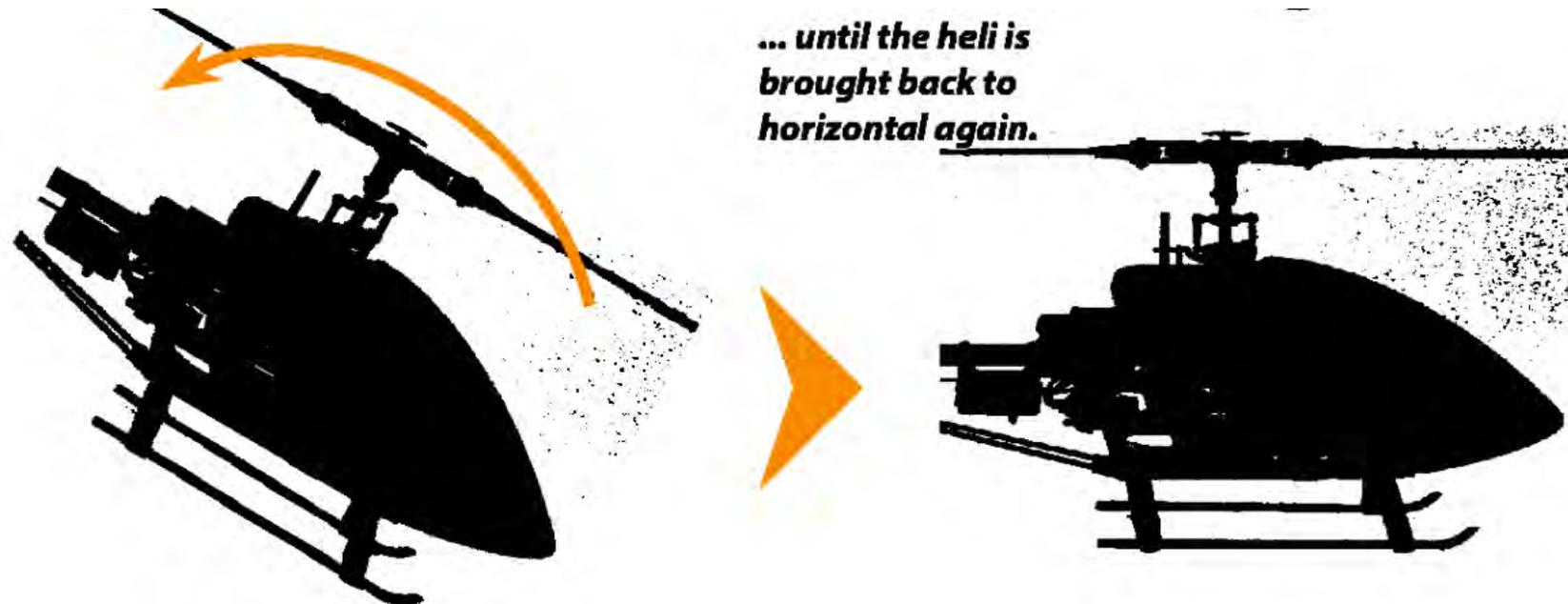
Ist hingegen die AttitudeControl ausgeschaltet, so fährt die Taumelscheibe im Betrieb stets langsam zurück in die Neutrallage, d.h. sie wird rechtwinklig zur Rotorwelle ausgerichtet, sobald der Helikopter (egal in welcher Lage) ruhig gehalten wird. Hier gleicht das System nur aktuell auftretende Drehbewegungen aus, korrigiert jedoch nicht die absolute Positionsabweichung.
